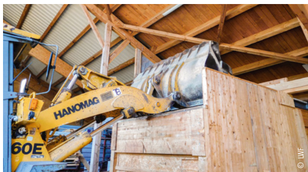
Sušara sa pokretnim dnom (sopstvena konstrukcija) (gore) i punjenje sušala pomoću utovarivača (dole)
