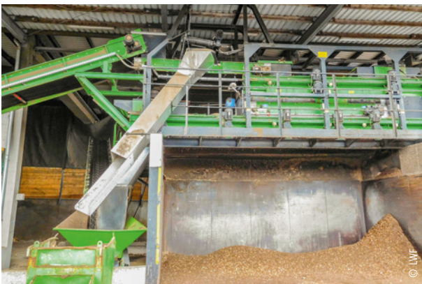
Sušenje u kontejnerima (šaržna sušara) sa otpadnom toplotom od biogasa (gore) i prosejavanje pomoću zvezdastog sita (dole)
