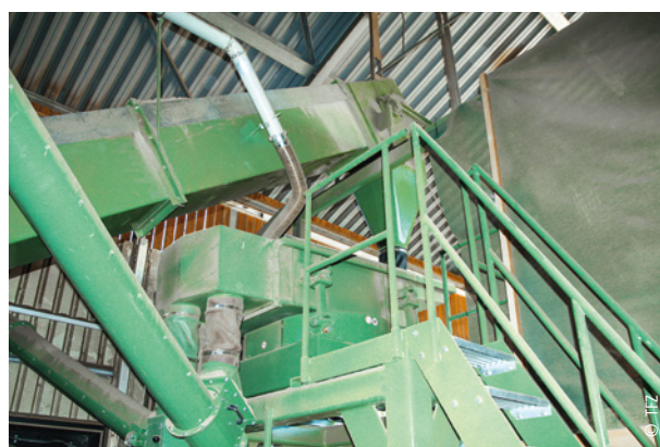
Allgaier sušara za valjkastim ležištem WB-T sa ciklonom (gore) Backer-vibraciono sito (dole)
