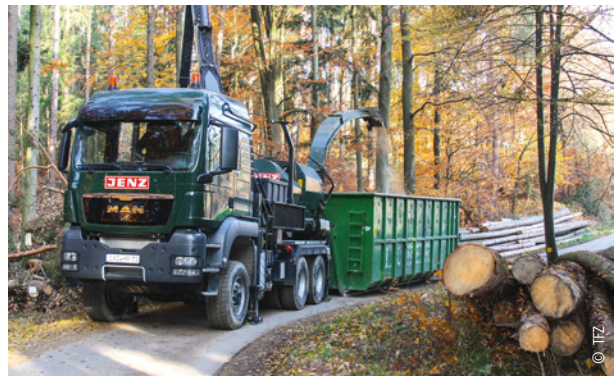
Proizvodnja drvne sečke od šumskih ostataka: prethodno naslagana drvena građa (gore) i iveranje na šumskom putu (dole)
