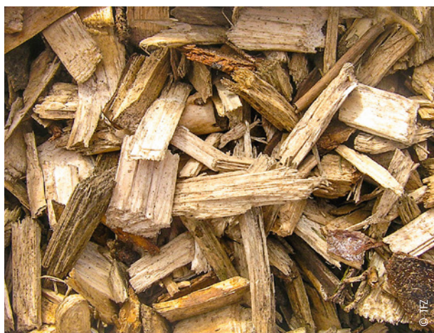
Sveža drvena sečka od šumskih ostataka (gore) pre i posle (dole) obrade iz studije slučaja 6a pomoću vibracionog sita i trakaste sušare. Drveni okvir DIN A 5
