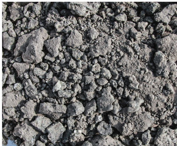
Primer ekstremnog formiranja šljake kod neadekvatnog kvaliteta goriva, sadržaj posude za pepeo u ložištu od 1,3 MW
