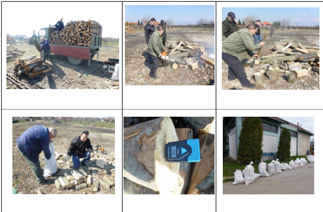
Слика 1. Припрема узорка дрвета (лево), мерење садржаја влаге (у средини) и вреће са упакованим количинама дрвета за свако мерно место (на дну, десно)
