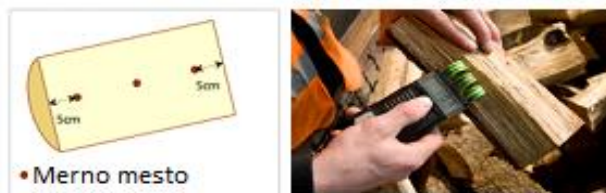
Slika 22 – Mesta merenja sadržaja vlage na cepanicama i komadima ogrevnog drveta
