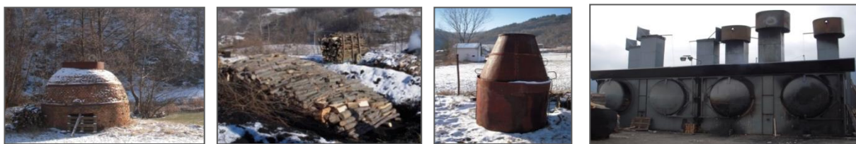
a) Zidana ćumurana b) Zemljana ćumurana c) Pokretna limena ćumurana d) Retorte
